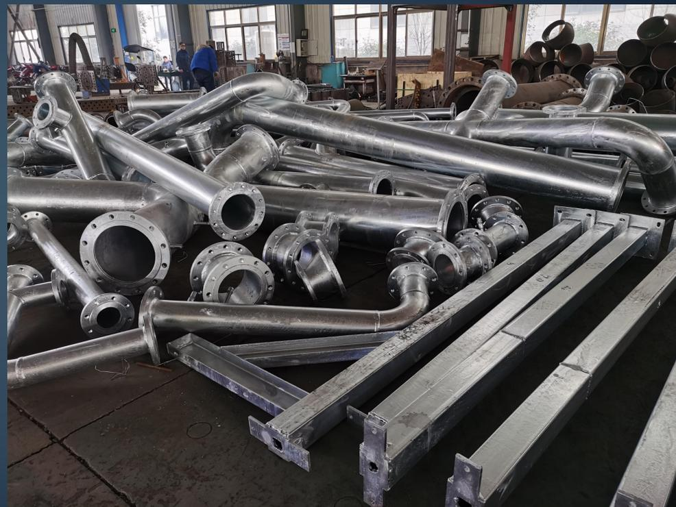
工厂化预制实现了装配式部品部件后镀锌防腐的可实施性。
